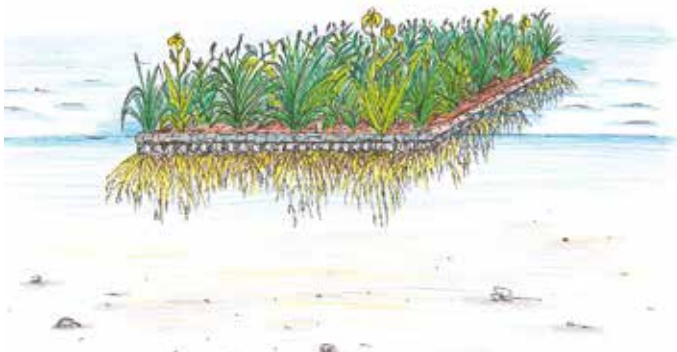
Abbildung 7.2.11 Schematischer Aufbau einer Röhrichtinsel.
