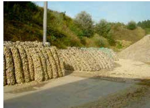
Abbildungen 3.9.2: Steinwalzen im Fertigungsbetrieb bei der Zwischenlagerung.
