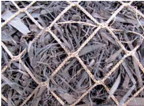
Abbildung 3.7.1: Dicht gelagerte Xylitfaser in einer Xylitwalze.
