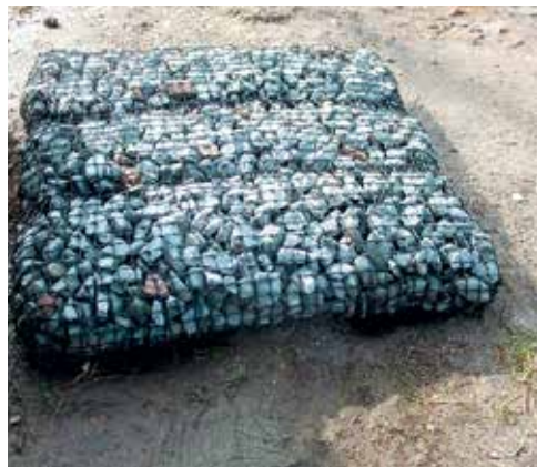
Abbildung 3.10.2 Schottermatratze, Abmessung 100 \times 100 \text{ cm} , Maschenweite 32 mm, Füllung 32/64, Dicke 12 cm.
