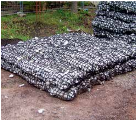
Abbildung 3.10.1 Steinmatratze, Abmessung 200 \times 200 \text{ cm} , Maschenweite 45 mm, Füllung 45/125, Dicke 20 cm.
