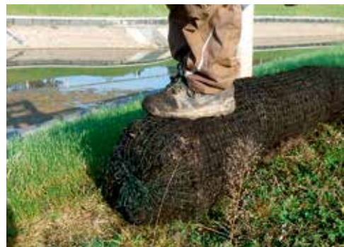
Abbildung 3.7.5: Auch bei einer Auflast von ca. 80 kg verändern die Xylitwalzen ihre Form nicht.
