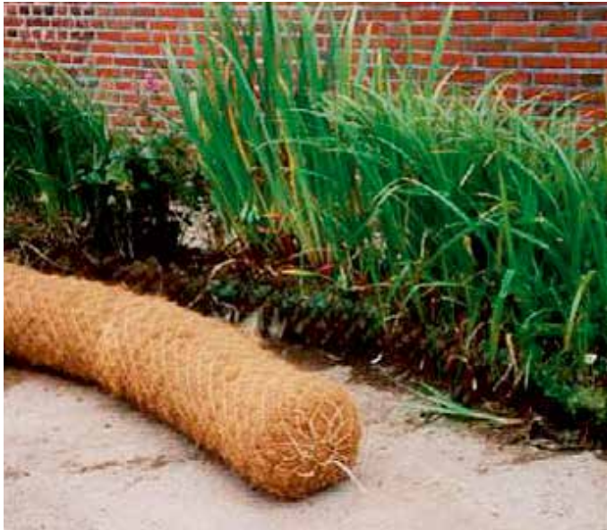
Abbildung 3.8.4 Links eine Kokoswalze und daneben eine gut entwickelte Röhrichtwalze. Diese hat schon mehrere Monate Entwicklungszeit hinter sich und ist bereits voll durchgewurzelt.
